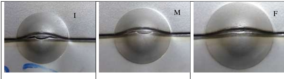
Figura 2 – Visual dos embutimentos realizados na solda nas regiões início (I), meio (M) e final (F).
